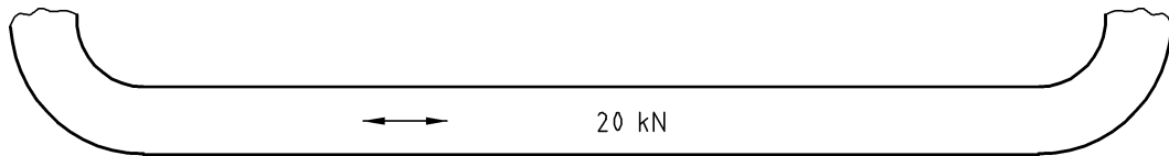
Bild 9 — Kennzeichnungsbeispiel für die Festigkeit in der Hauptachse bei geschlossenem und verriegeltem Verschluss
